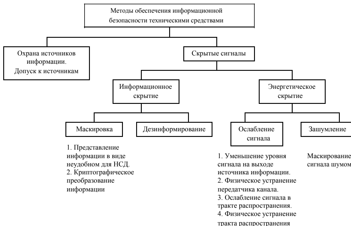
Рис. 13 Классификация методов обеспечения информационной безопасности на основе технических средств
